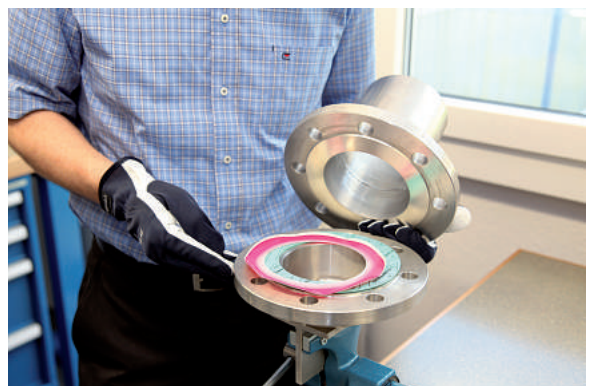
Das drucksensitive Fuji-Papier zeigt auf, ob der Flansch fachgerecht verschraubt wurde.
