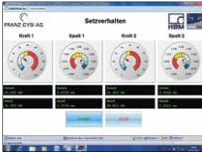
Mesure électronique de la mise en place d'un joint
