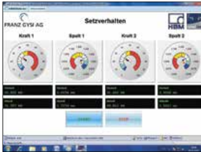
Elektronische Messung des Setzverhaltens einer Dichtung
