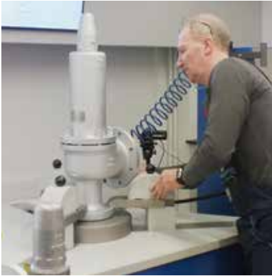
Prüfstand mit maximalen Prüfdruck von 300 bar.
