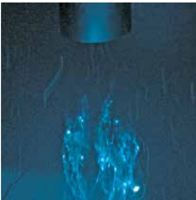
Demonstration von thermischen Schlägen und Kavitation
